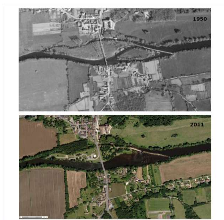
Figure 4 - Evolution aux abords du seuil de Ruffec entre 1950 et 2011 : Dérasement de l'île située à l'aval du seuil au début des années 70.
