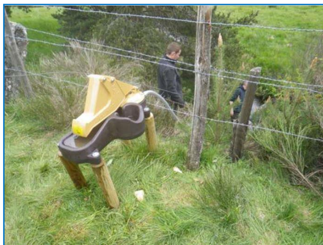
Figure 15 : Photo exemple d'une pompe de prairies dans la maîtrise du piétinement bovin
