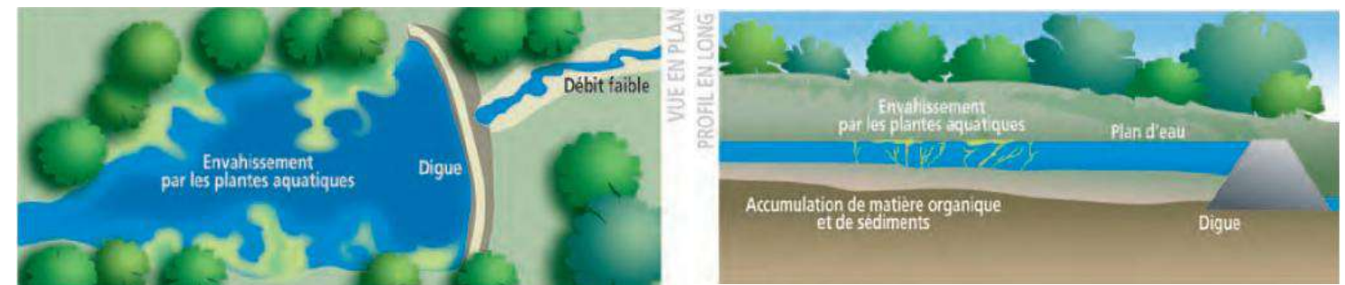
Figure 7: Situation dégradée. Recueil d'expériences sur l'hydromorphologie: ONEMA, Agences de l'Eau.
