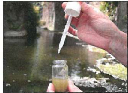
Photo 12. Fixation du prélèvement
