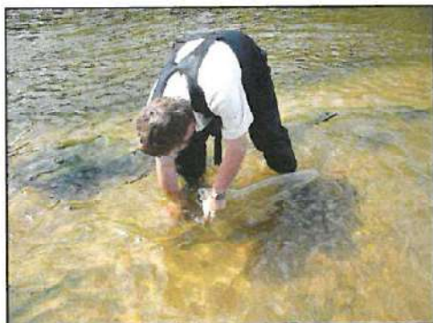
Photo 7. Prélèvement à l'aide d'un filet surber
