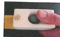
Photo 14. Interrupteur électrique intégré au manche de l'anode.
